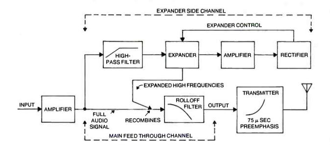
Fig. 9-8. The Dolby B system for FM.
