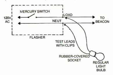
Fig. 12-7. A simple flasher test unit.
