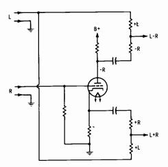
Fig. 10-31. Inverter-tube stereo matrix.
