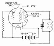
Fig. 11. Dynatron Oscillator
