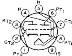
HEATER VOLTAGE (AC/DC) ..... 6.3 volts
