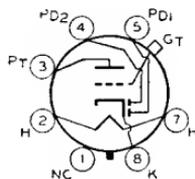
**TRIPLE DIODE—HIGH-MU TRIODE**
