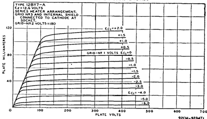
**GRID-NO.1 (CONTROL-GRID) VOLTAGE:**
