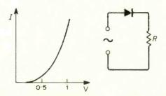
Fig. 10.1. Simple diode rectifier.
