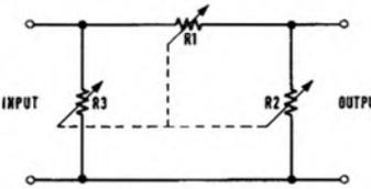
FIG. 7 THE LADDER ATTENUATOR
