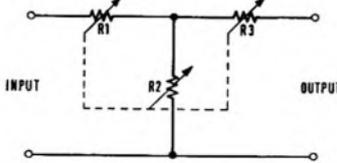
FIG. 6 THE  $\pi$ -ATTENUATOR
