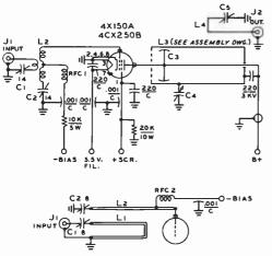
ALTERNATIVE GRID CIRCUIT FOR 432 MHZ AMPLIFIER
