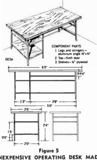
INEXPENSIVE OPERATING DESK MADE FROM ALUMINUM ANGLE STOCK, PLY-WOOD AND A FLUSH-TYPE DOOR
