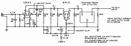
**CLIPPER FILTER USING 6AL5 STAGE**
