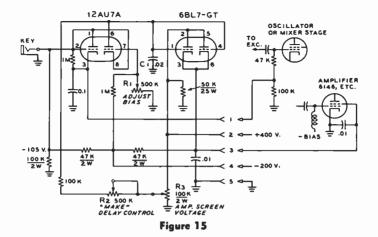
DIFFERENTIAL KEYING SYSTEM FOR SCREEN CIRCUIT
