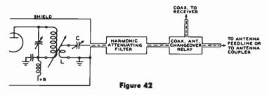
**TUNED-LINK OUTPUT CIRCUIT**
