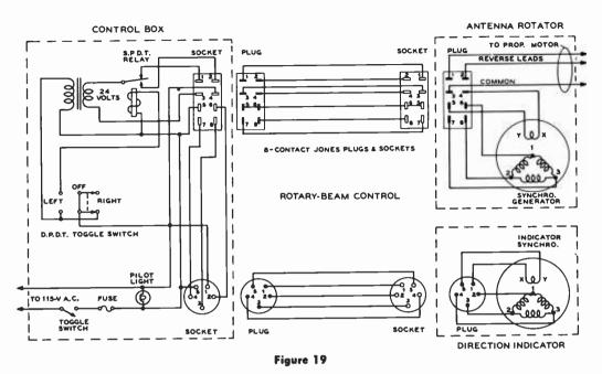
SCHEMATIC OF A COMPLETE ANTENNA CONTROL SYSTEM
