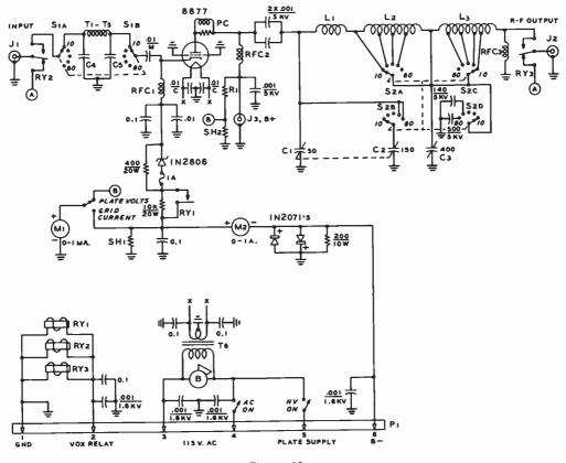
SCHEMATIC, KW-2 HEAVY DUTY LINEAR AMPLIFIER
