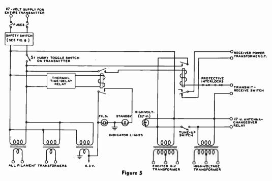
TRANSMITTER CONTROL CIRCUIT
