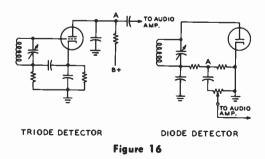
CONNECTION OF THE OSCILLOSCOPE ACROSS THE DETECTOR LOAD
