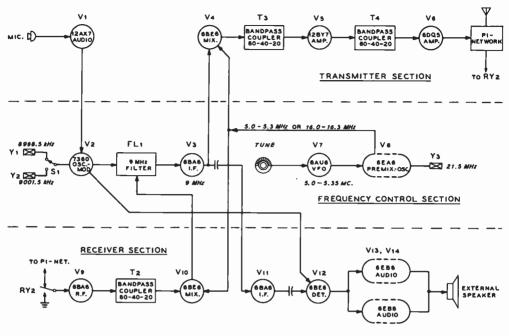
BLOCK DIAGRAM OF TRANSCEIVER
