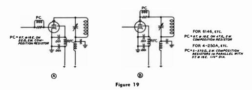
PLATE AND GRID PARASITIC SUPPRESSION IN TETRODE TUBES
