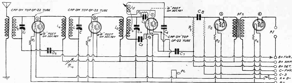
THE CIRCUIT DIAGRAM OF THE FIVE TUBE SCREEN GRID DIAMOND OF THE AIR.
