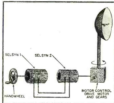
Fig. 14. A selsyn motor system.
