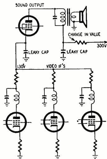
Fig. 8—B-plus path in series-tube set.
