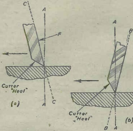
Fig. 1.—Measuring the heel angle.
