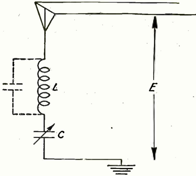
AN ORDINARY TUNED ANTENNA CIRCUIT
