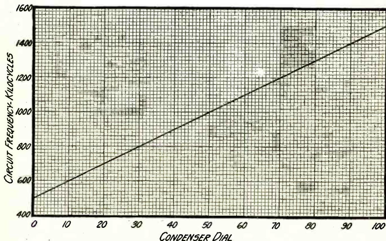
THE STRAIGHT-LINE-FREQUENCY TUNING CURVE
