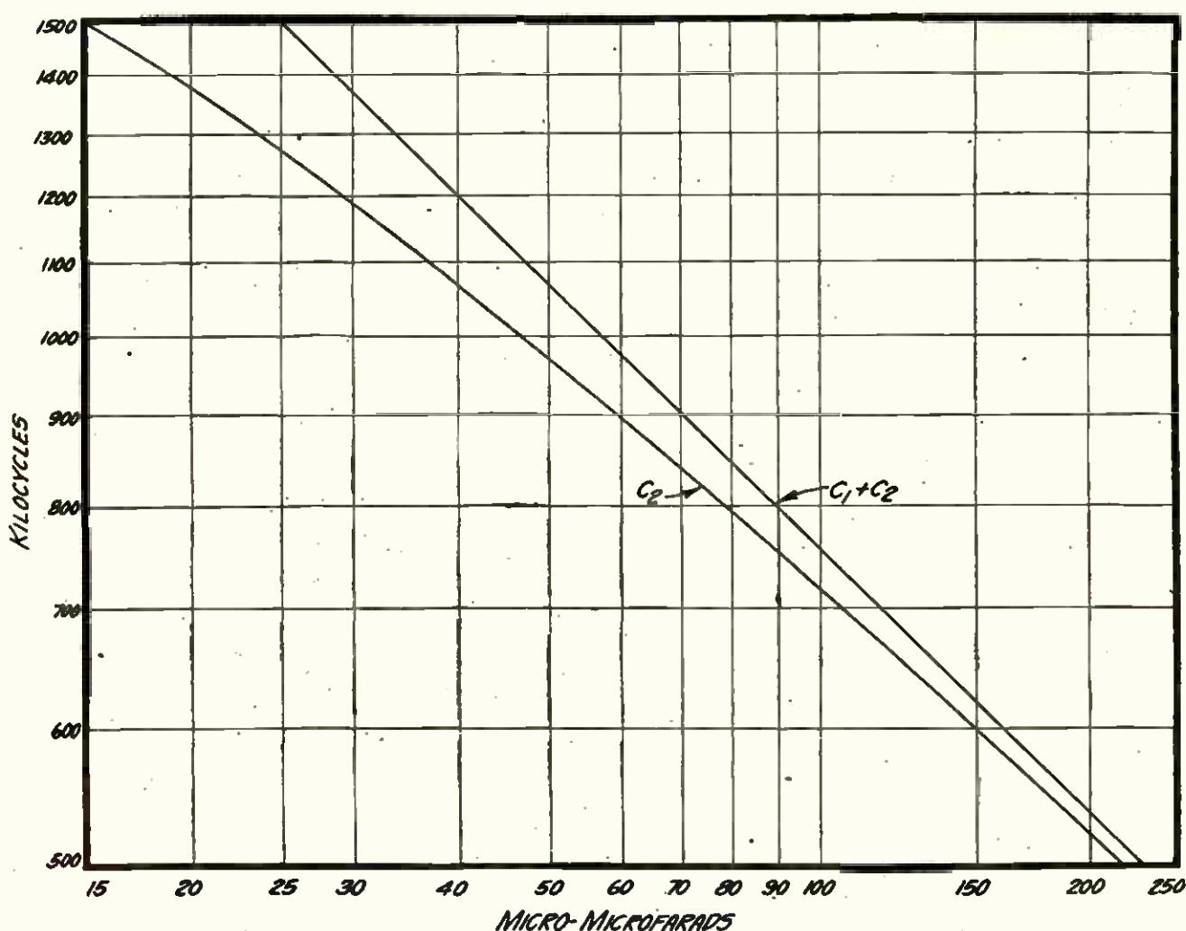
THE CAPACITY-FREQUENCY CURVE
