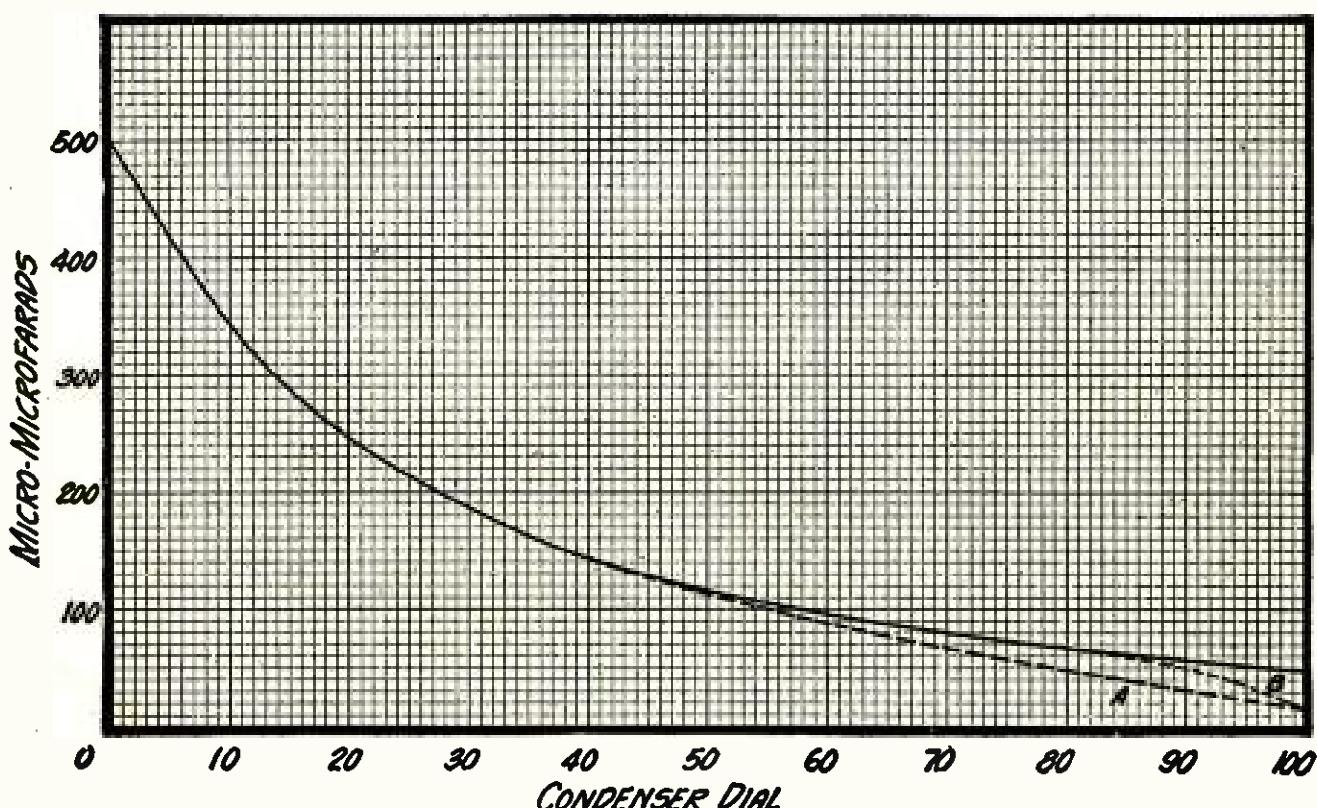
THE CAPACITY CURVES FOR A 500 MICRO-MICROFARAD CONDENSER
