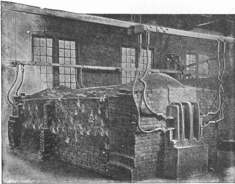
CARBORUNDUM FURNACE DURING OPERATION
