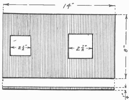
FIG. 98. FIBRE HEAD
