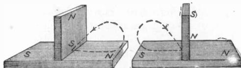
FIG. 116. MAKING A MAGNET
