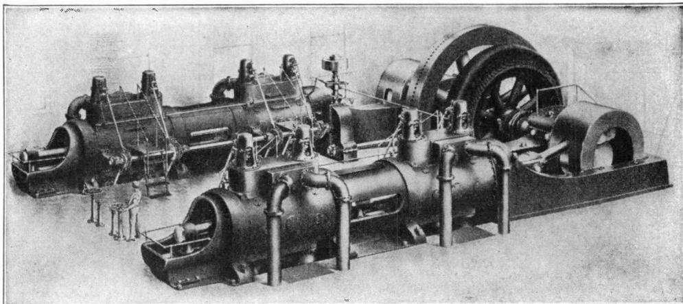
A TYPE OF MODERN GAS ENGINE FOR DRIVING ELECTRIC GENERATORS—
