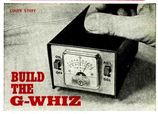
SIMPLE ACCELEROMETER MEASURES POSITIVE OR NEGATIVE G FORCE
