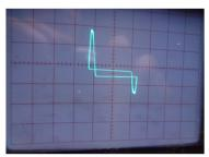
E-B GOOD SILICON TRANSISTOR SLIGHT ZENERING, LEADS REVERSED
