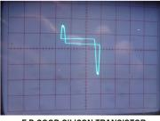
E-B GOOD SILICON TRANSISTOR SLIGHT ZENERING
