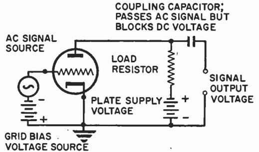
**BASIC VACUUM TUBE AMPLIFIER CIRCUIT**
