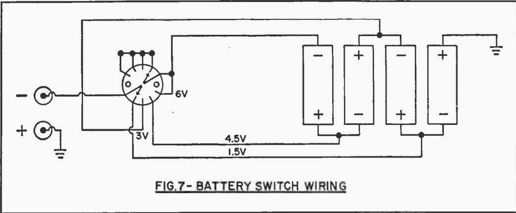
FIG. 7- BATTERY SWITCH WIRING
