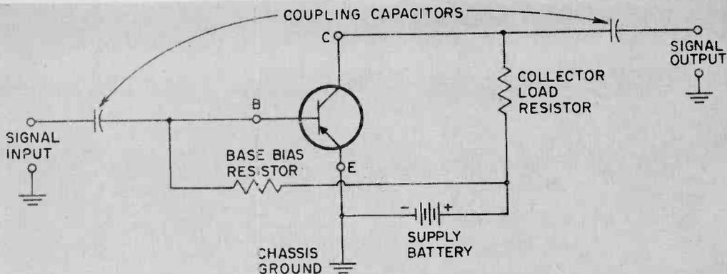
SIMPLE AC SIGNAL AMPLIFIER STAGE USING NPN TRANSISTOR
