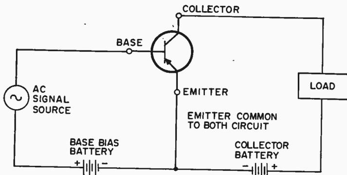
BASIC COMMON-EMITTER AMPLIFIER USING NPN TRANSISTOR
