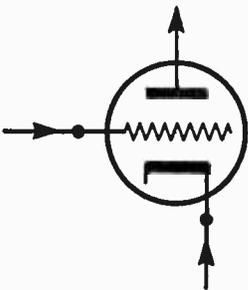
THE RESISTANCE OF THE TRIODE VACUUM TUBE IS VARIED BY CONTROLLING THE GRID VOLTAGE
