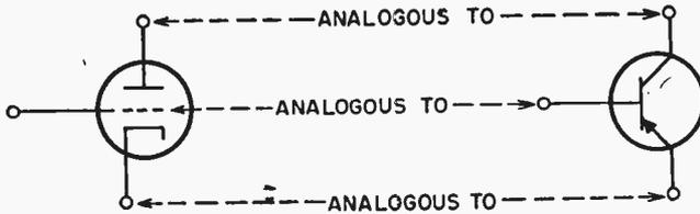
ANALOGIES BETWEEN THE VACUUM TUBE AND THE TRANSISTOR
