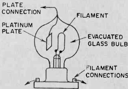
THE FLEMING VALVE ; FORERUNNER OF THE THREE-ELEMENT VACUUM TUBE .
