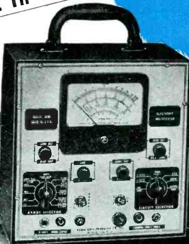
MODEL 668 VACUUM TUBE VOLT, OHM, CAPACITMETER
