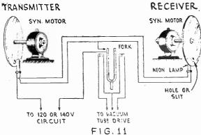
RECEIVER. SYN. MOTOR SYN. MOTOR NEON LAMP
