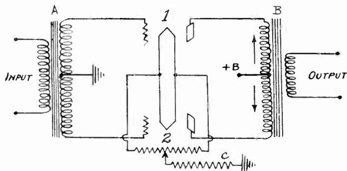
Fig. 15 - PUSH-PULL AMPLIFIER CIRCUIT DIAGRAM.
