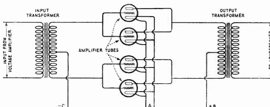
Fig. 25 - SCHEMATIC DIAGRAM SHOWING A STAGE OF PUSH-PULL PARALLEL AMPLIFICATION.
