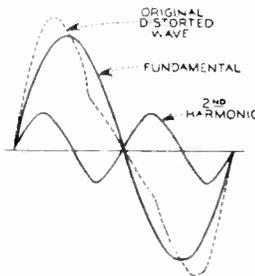
Fig. 3 - ILLUSTRATING THE BREAKING DOWN OF A SINE WAVE.
