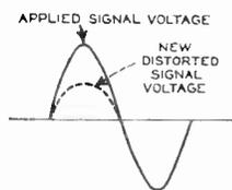
Fig. 9 - DISTORTION DUE TO GRID GOING POSITIVE.
