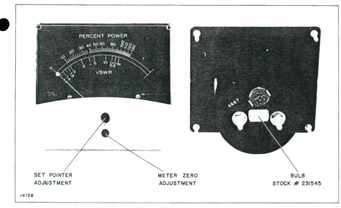
Figure 16. Panel Meter 4M2
