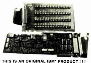
IBM PC\*DATA **ACQUISITION** AND CONTROL **ADAPTER**
