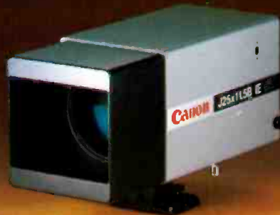
J25x11.5B1E para cámaras de 2/3". Mayor alcance. Una lente con enfoque ajustable de 25X, especialmente diseñada para las cámaras de 2/3". La potencia y el alcance de los sistemas de 1" combinados con la economía y eficiencia de las cámaras de 2/3". Distancia focal: 11.5-288 mm (23-576 mm con extensor de 2X) Apertura relativa máxima: 1:1.6 hasta 220 mm 1:2.1 en 288 mm
