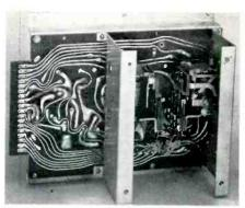
OSCILLATOR CIRCUIT OF RCA BTA-1R
