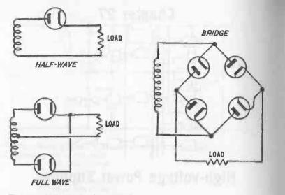
Fig. 27-1. Three basic rectifier circuits.
