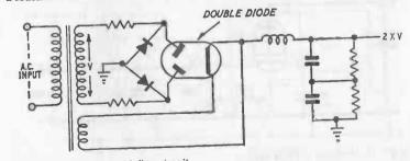
Fig. 27-9. Voltage-multiplier circuit.
