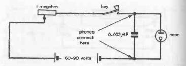
Fig. 10-4. Morse code flasher circuit.
