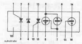
Fig. 14-1. CA3097E IC array (schematic)
