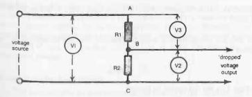
Fig. 3-7. Basic potential divider circuit.
