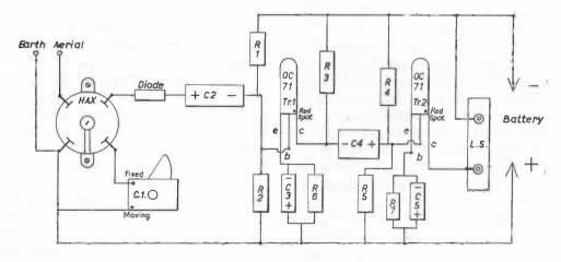
Fig. 30 Wiring Diagram
