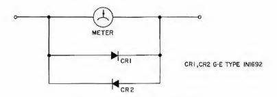
Figure W1.1 Meter protection rectifiers
