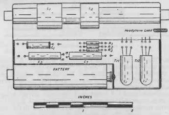
FIG. 9. LAYOUT FOR THE MATCH-BOX RECEIVER
