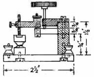
Fig. 49.-The Crystal Detector.
