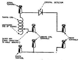
Fig. 98 .- Circuit Diagram.
