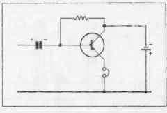
FIG. 37. EARTHED-COLLECTOR AMPLIFIER.
