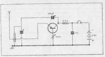
FIG. 22. SIMPLE TRANSISTOR RECEIVER.
