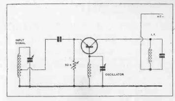
FIG. 28. FREQUENCY CHANGER USING POINT-CONTACT TRANSISTORS.
