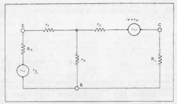
FIG 44. EARTHED BASE EQUIVALENT A.C. NETWORK.
