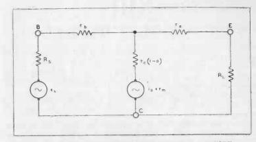
FIG. 47. EARTHED-COLLECTOR EQUIVALENT A.C. NETWORK.
