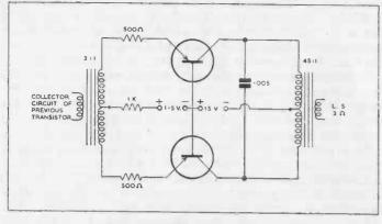
FIG. 24. PUSH-PULL OUTPUT STAGE.
