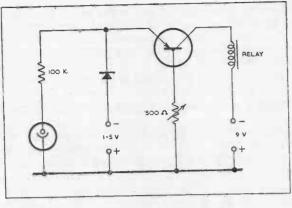
FIG. 31. TRIGGER CIRCUIT.
