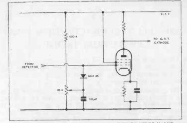
FIG. 13. TV SPOT LIMITER IN GRID CIRCUIT OF VIDEO VALVE.
