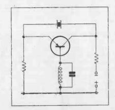
FIG. 30. CRYSTAL CONTROLLED TRANSISTOR OSCILLATOR.
