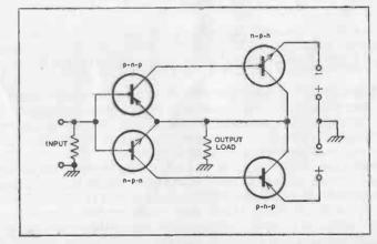
FIG. 41. A PUSH-PULL AMPLIFIER USING COMPLEMENTARY SYMMETRY.
