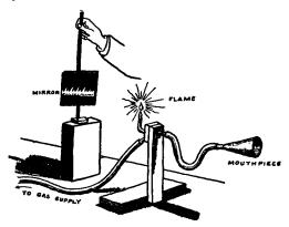
FIG. 129.—Koenig's manometric flame apparatus.
