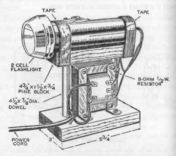
LIGHT SOURCE MADE FROM A FLASHLIGHT FOR OPERATION ON 117-V A.C.
