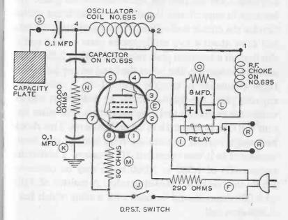
CIRCUIT FOR THE EXPERIMENTAL CAPACITY RELAY
