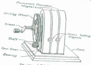
FIG. 251. - A Telephone Magneto.
