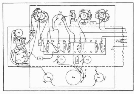
Fig. 9. Input section wiring diagram.
