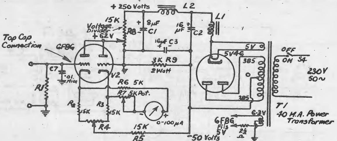
**FIGURE (2) Basic D.C. Voltmeter Circuit**
