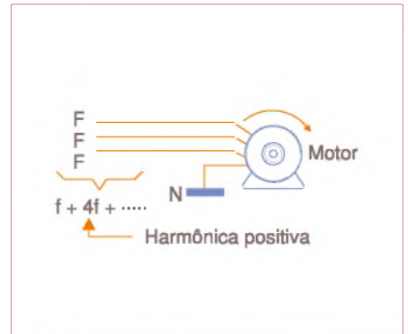
F5. Influência das harmônicas positivas no motor assíncrono trifásico de 4 fios.
