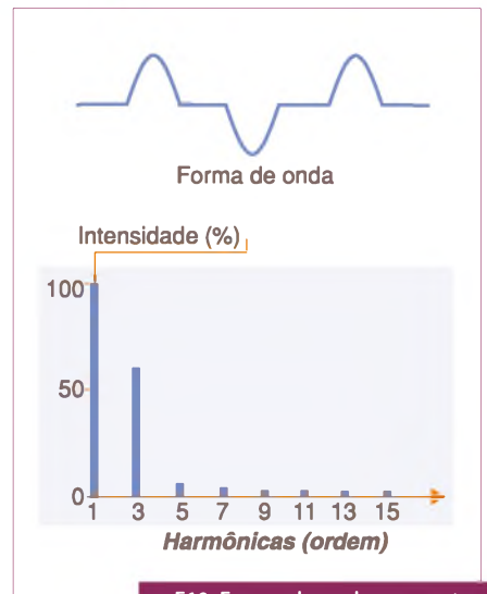
F18. Forma de onda e espectro para a máquina de solda.
