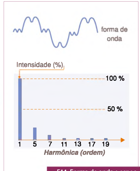
F14. Forma de onda e espectro do retificador trifásico.
