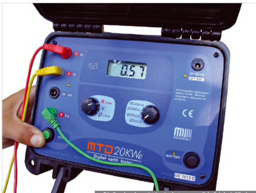
F9. O valor da resistência de terra medida foi de 0,57 ohms.
