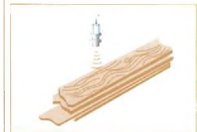
Sensor de nível máximo de estocagem de madeira
