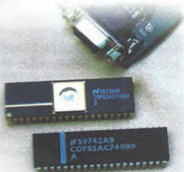
Fig. 9 - COP "Janelado" e "OTP".
