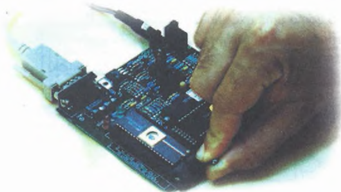
Fig. 10 - Inserindo COP8 no soquete ZIF da gravadora EPV.
