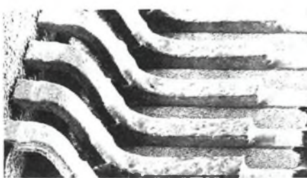
Fig. 12.18: Terminais de CI VSO soldados.
