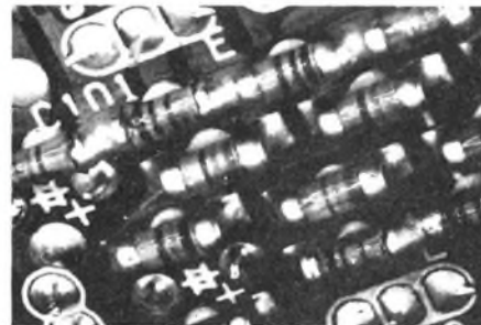
Fig. 12.2: Pontes de solda entre resistores MELF adjacentes.
