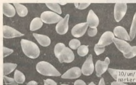
1. partículas em forma de pera, fração de peneira de 50 a 70 \mu\text{m} .
