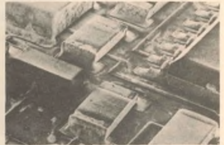
Fig. 9.14: O mesmo substrato da figura 9.13, após a montagem e soldagem dos componentes.
