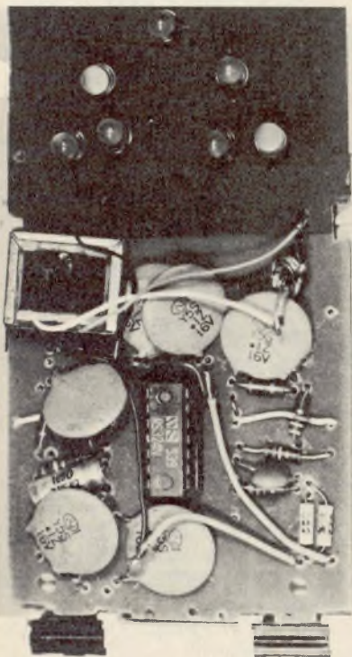
Fig. 4 - Montaggio interno del prototipo: il trasformatore è stato incollato alla bassetta circuitale.
