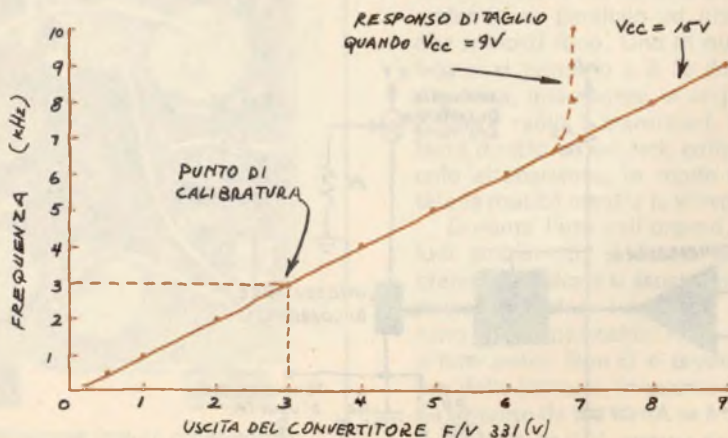
Fig. 3 - Grafico della tensione d'uscita in funzione della frequenza d'entrata di un convertitore da frequenza a tensione con un LM331.
