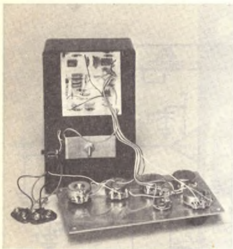
Illustrazione del montaggio interno e dei potenziometri fissati sul pannello frontale.
