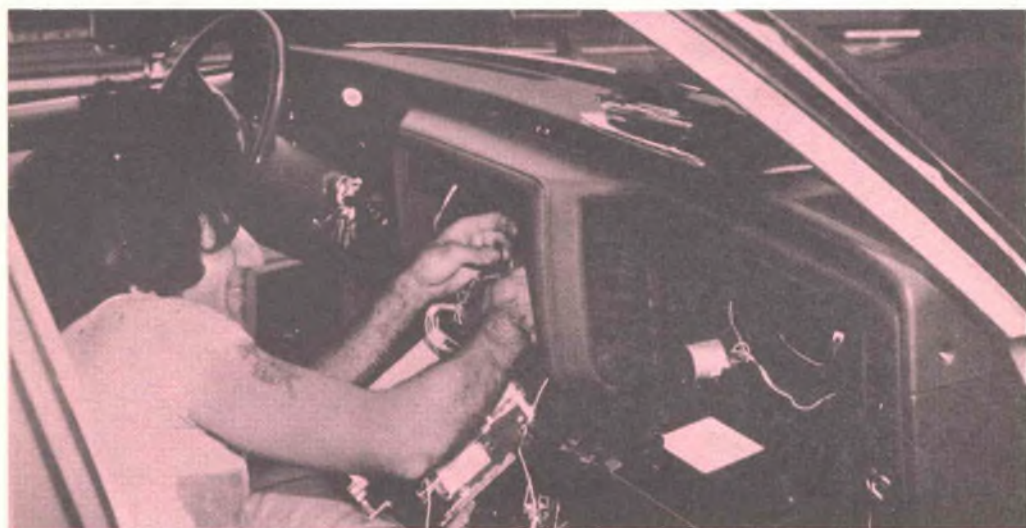
L'installazione di un apparato mobile CB non è generalmente un compito arduo. Può essere tuttavia alquanto difficile quando un'antenna elettrica MA-MF viene sostituita con una CB-MA-MF perché l'autoradio deve essere tolta per effettuare i collegamenti di alimentazione.
