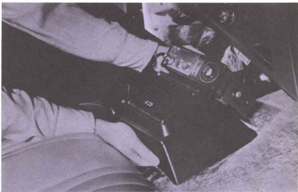
Per esaltare il suono, questo montaggio di un altoparlante esterno e di un apparato CB viene effettuato sul tunnel della trasmissione della vettura. Per sicurezza contro i ladri, si possono asportare le due unità e nasconderele nel bagagliaio.
