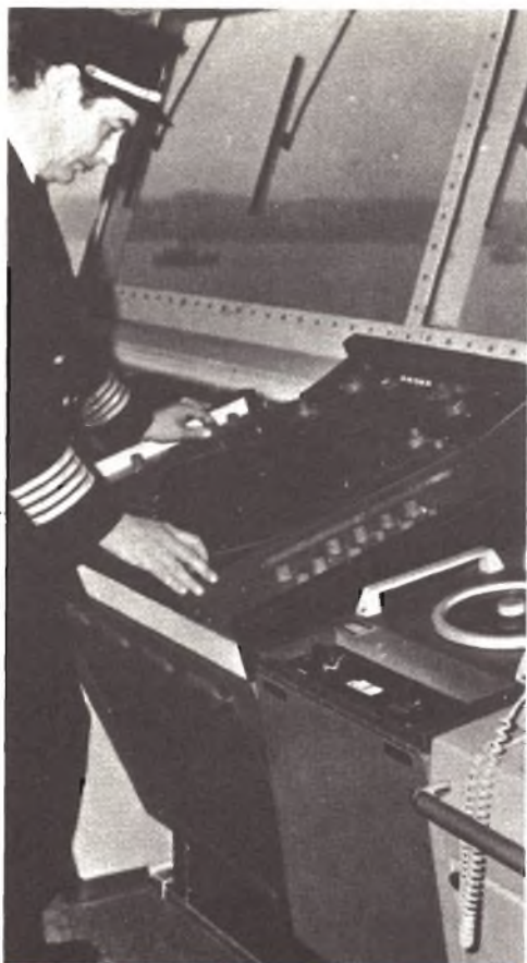
In questa fotografia è visibile il radar marino Clearscan, recentemente presentato dalla ditta inglese Decca Radar, già installato sul ponte di una nave.
