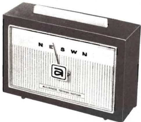
Il sistema di controllo qui illustrato impiega uno strumento indicatore.
