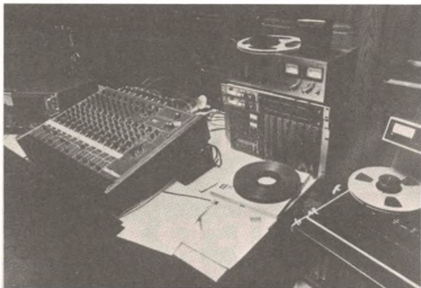
Le apparecchiature della sala di controllo. Si notano il banco di regia, un angolo della piastra di trascinamento del nastro (a destra), l'oscilloscopio ed il voltmetro (all'estrema sinistra).
