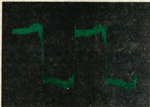
Segnale di uscita ottenuto durante la prova dell'onda quadra.
