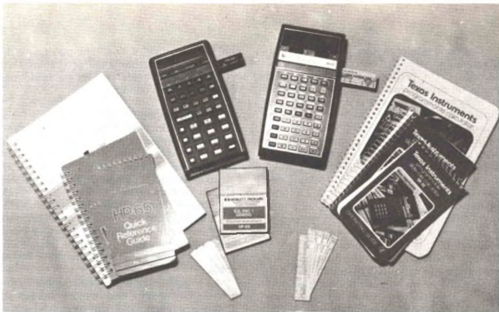
I modelli HP-65 (a sinistra) e SR-52 (a destra) sono due calcolatori portatili interamente programmabili. In entrambi vi è un lettore di cartoline programmatiche magnetiche miniatura.
