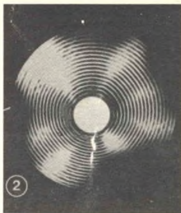
Interferogramma ottenuto da un cono al quale è stata applicata una frequenza di 9.000 Hz; ora l'intera superficie è coperta da nodi ed antinodi e il cono irradia un suono debole.
