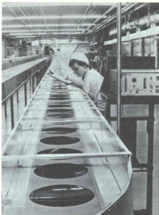
Fig. 3 - I dischi vengono fatti passare attraverso un tunnel dove avviene la stabilizzazione delle caratteristiche; l'ambiente è rigorosamente controllato. E' qui visibile un misuratore delle particelle eventualmente presenti su ogni disco.
