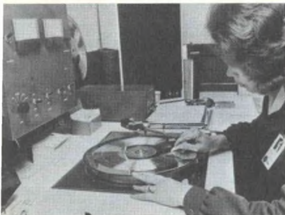
Fig. 5 - La "madre" di metallo viene riprodotta su un giradischi per controllare eventuali difetti che verranno eliminati con un procedimento di "microchirurgia".
