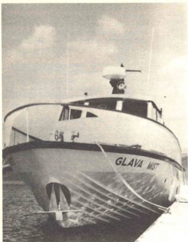
Il sistema di scansione del radar Seascan montato sul nuovo yacht a motore Christina da 15,8 m. Il sistema di scansione si adatta alle moderne linee del natante.
