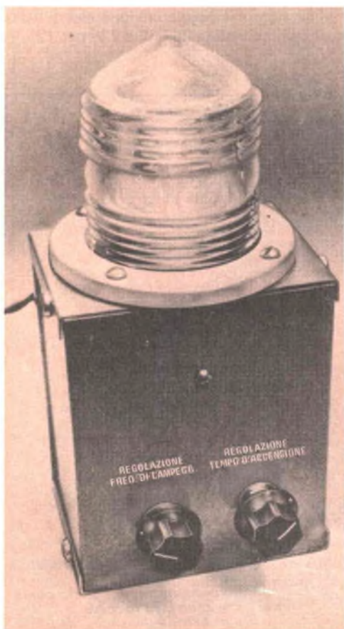
La lente di Fresnel si fissa nella parte superiore della scatola.
