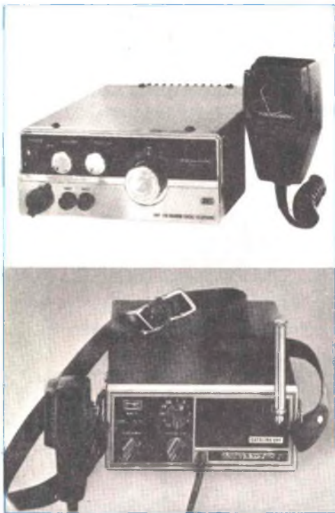
Ricetrasmittitore a dodici canali Modello TRM-12 della Realistic (in alto); ricetrasmittitore munito di batterie Modello Catalina della Pearce-Simpson (in basso).
