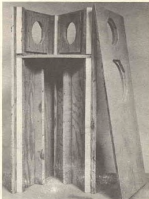
Fig. 3 - Costruzione parziale del mobile. Il legno pressato consentirà una maggiore densità rispetto al legno compensato.
