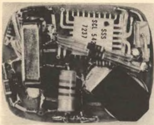
Questa fotografia del prototipo mostra come siano ravvicinati i componenti sul circuito stampato. Si noti che i terminali del cristallo e dei resistori sono ricoperti con sottile tubetto isolante.
