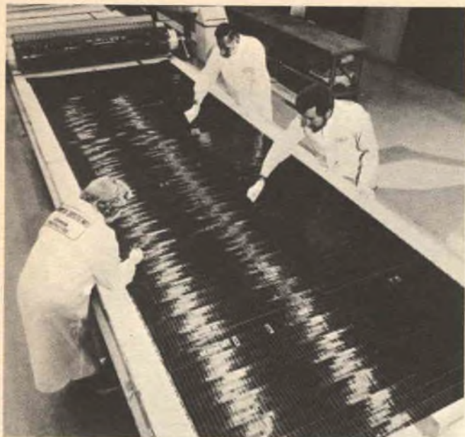
Fig. 8 - Pannelli avvolgibili ricoperti di celle solari, denominati EPUSA, realizzati presso la Hughes.
